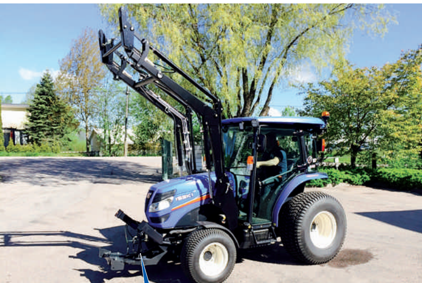
Koneessa voi olla yhtäaikaan kiinni PK-haarukka ja kuormain
